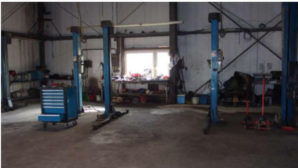
Abb. 4: Blick nach Osten in der Werkstatthalle auf die elektrischen Hebebühnen. Im linken Bildrand ist ein Regal mit flüssigen Betriebsmitteln (Bremsflüssigkeit, Öle etc.) zu sehen. Der Boden darunter ist sauber. Es sind keine öligen Flecken zu erkennen.
