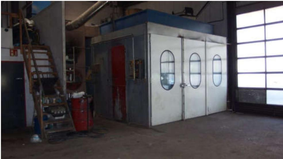
Abb. 3: Blick nach Nordwesten auf die Lackierkabine (Nr. 18 im Ergebnisplan) in der Werkstatthalle. Die Lackierkabine hat eine Absaug- und Belüftungsanlage an der Seite.
